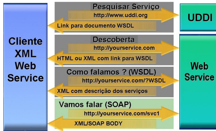
Figura 6 – Mensagens trocadas na invocação de um Web Service
